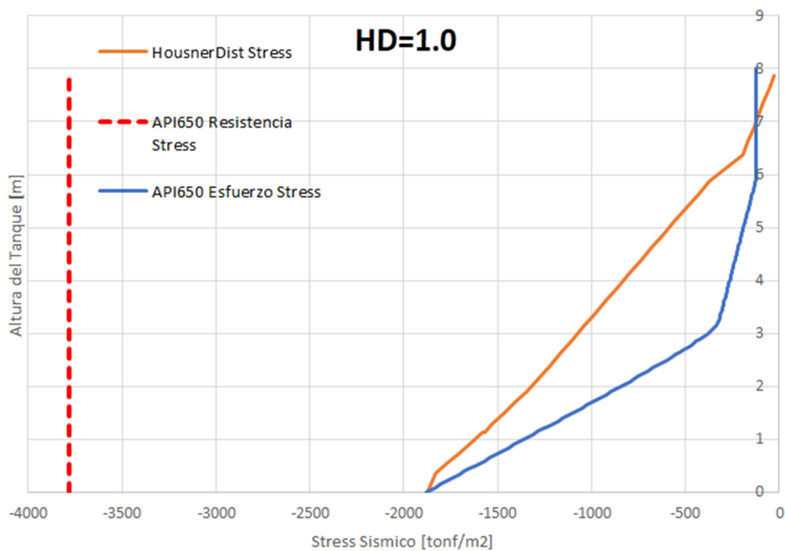
Figura V-4. Tensiones en las paredes del estanque H/D=1.0 en [tonf/m 2 ].
